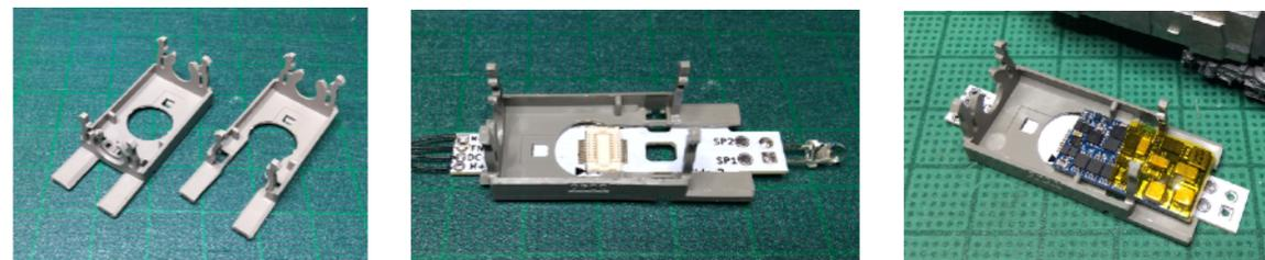
⑤床下にスピーカー(15mmx11mm、nagodenさん頒布品推奨)を固定します。スピーカーとフライホイールやウオームの軸が当たらない様に調整してください。スピーカーからは5cmほどの配線を取り出し、EL-タイプHのSP1,SP2にはんだ付けします。
