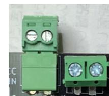
ACアダプタ(DC出力)をつなげば、DCCコマンドステーションの電流負荷を低減できます。
